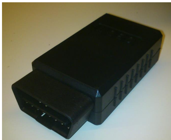
Figura 2. Envoltente estándar para el OBD
